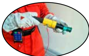
3 AC-Blastcontrol III trådlös fjärrstyrning
