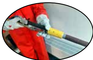
1.2 Dödmansgrepp för luftstyrning med ventil för blästermedel avlöp
