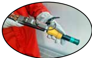
1 Dödmansgrepp för luftstyrning med säkerhetslina
