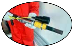
2 Dödmansgrepp för elstyrning med uttag för belysning
